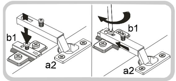
Regulacja drzwi/Adjustment of door/Türeneinstellung/Регулировка лицевых элементов
